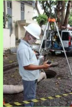
Fig. 08 - Teste de resposta dos sensores (bump-test) - Preparação para monitorar a atmosfera interna.
